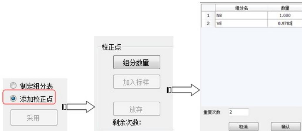
6、单击“加入标样”，打开谱图 VE 标样 1.NCH，完成一次校正，再点击“加入标样”打开谱图 VE 标样 2.NCH，完成本次平行两点校正。
